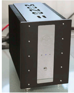
Премьера выставки: впервые в России были продемонстрированы моноусилители мощности Accoustic Arts Mono II, дополнившие собой флагманскую линейку Reference. Тороидальный трансформатор мощностью 1200 ВА, конденсаторы ёмкостью 80000 мкФ и 12 отобранных транзисторов MOSFET обеспечивают выходную мощность 500 Вт на 4-омной нагрузке. На комфортных уровнях звучания усилитель работает в классе А. Вручную собран в Германии из первоклассных комплектующих
