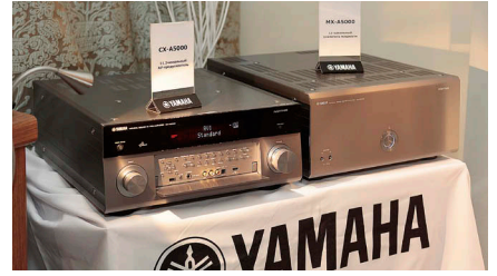
Кредо Yamaha — чем больше каналов, тем лучше. AV-предусилитель CX-A5000 Aventure с конфигурацией 11.2 и 11-канальный усилитель мощности MX-A5000
