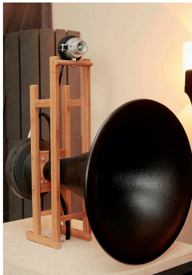
Ещё одна отечественная разработка — система KSL-Audio. Крупнокалиберный бас, рупорная середина и компрессионный ВЧ-драйвер без оформления
