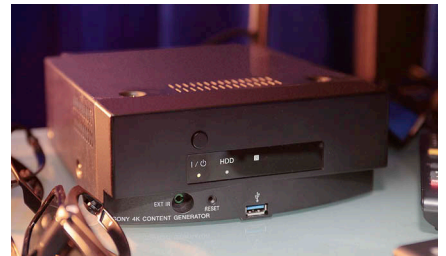
4К-генератор Sony F1 Vxh. Один из немногих источников, способный выдать реальную картинку в разрешении 4096 x 2160
