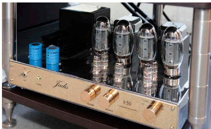
Ламповый звук и изысканный дизайн из Франции. Интегральный усилитель Jadis I-50 имеет встроенный USB-конвертор и комплектуется пультом ДУ. Недавно разработанные лампы KT150 обеспечивают мощность 2 x 50 в чистом классе А
