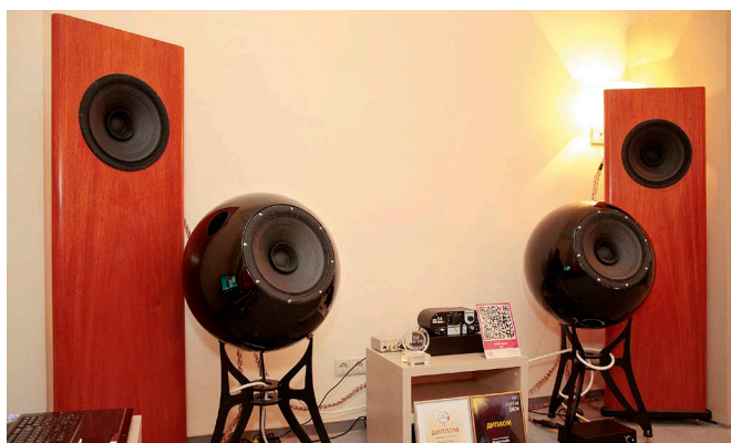
Ещё одна отечественная разработка — сферическая акустика FR-12 компании Round Audio. 12-дюймовый широкополосник с дополнительным ВЧ-конусом работает в закрытом оформлении. Диапазон воспроизводимых частот 60 — 16000 Гц ( \pm 3 дБ). Сочетание оптимальной формы и отсутствия кроссоверов даёт очень интересный эффект. Советуем послушать
